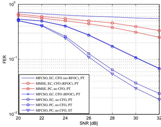
Fig. 6: Frame-Error-Ratio ( $2 \times 2$  SM, CQI=15, 5 MHz band)
